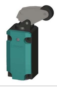
SIRIUS POSITION SWITCH, ATEX METAL ENCLOSURE 40MM TO EN50041 DEVICE CONNECTION 1X (M20X1.5) 1NO/ 1NC SNAP-ACTION CONTACTS ANGULAR STAINLESS STEEL ROLLER LEVER AND PLASTIC ROLLER 22MM
