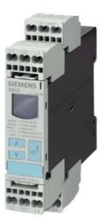
ANALOG MONITORING RELAY PHASE SEQUENCE MONITORING 3X 360 TO 520V AC 50 TO 60 HZ 2 CHANGEOVER CONTACTS SPRING LOADED CONNECTION
