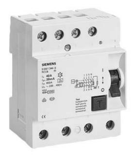
RES.CURRENT OP.CIRCUIT BREAKER TYPE A PSE/SSF D=55MM 63A 3+N-POL IFN 0,3A 400V 4MW FOR SELECTIVE SWITCH OFF
